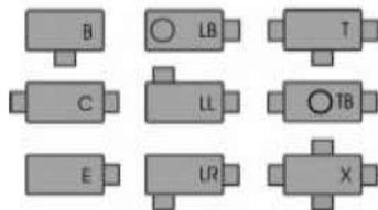
Caixa de passagem ou de ligação de equipamento, para instalação abrigada, com entradas lisas, construída em liga de alumínio de alta resistência mecânica e à corrosão, isentos de qualquer rebarba, tampa aparafusável no mesmo material da caixa, e guarnição de borracha para vedação. Acabamento alumínio natural polido ou em pintura epóxi na cor cinza. Para instalações externas, as entradas devem ter roscas do tipo BSP
