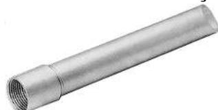
Eletroduto rígido de aço-carbono com costura, tipo pesado, classe LI, com revestimento protetor anti-oxidante, **galvanizado à fogo**, rosca conforme NBR 8133, fornecido em barras de 3 m de comprimento com uma luva.
